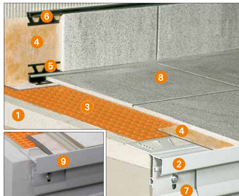
Ejemplo constructivo con perfil para bordes de balcones 9 Schlüter-BARA-RTKEG
