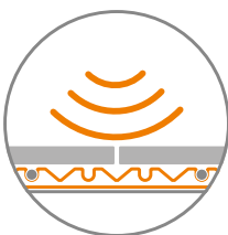
Aislamiento acústico a ruido de impacto
